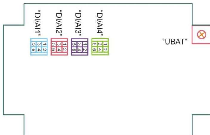
Rozmieszczenie i numeracja przełączników kodowych konfiguracyjnych
